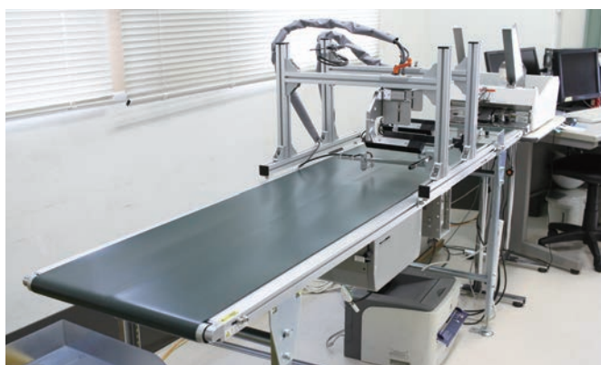
▲画像検査装置で宛名やバーコードの印字内容・状態を確認します。
